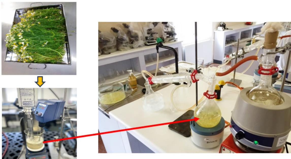
*Nota.* Esquema del aparato experimental para extracción de aceite.
