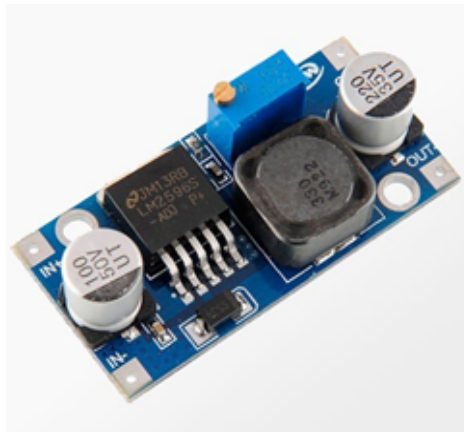
Figura 6 Regulador de voltaje
