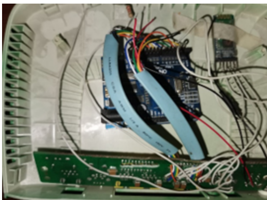
Figura 13 Colocado de hardware en carcasa de router
